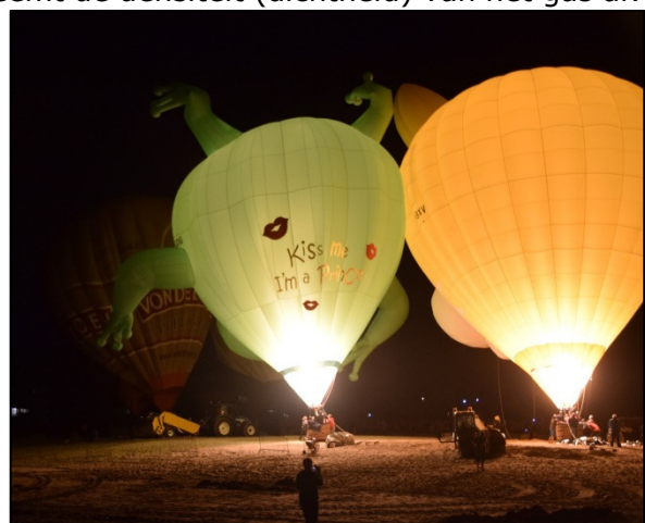
Figuur 1 Een heteluchtballon stijgt op omwille van het verschil in densiteit tussen de warme en de koude lucht. (Foto: Niels De Ruyck)
