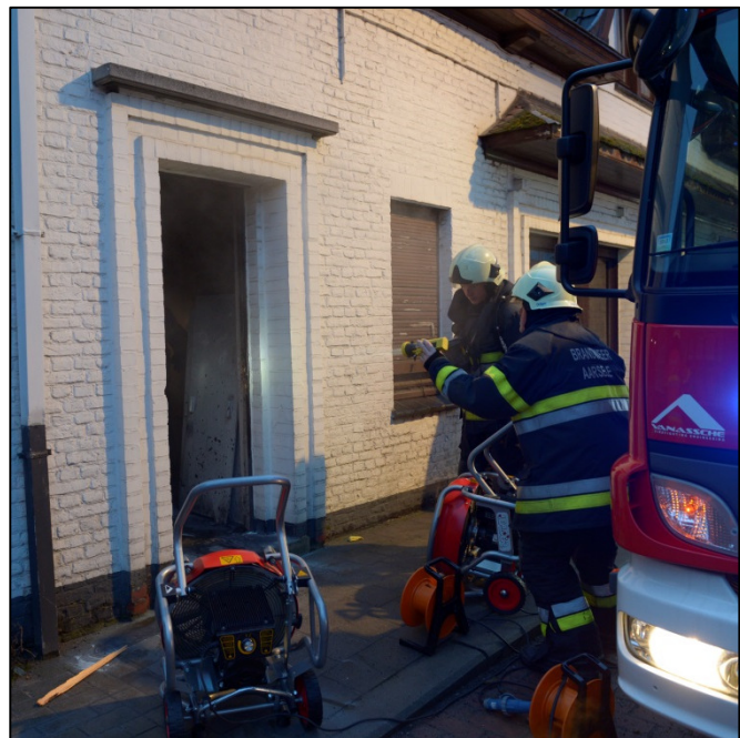
Figuur 4 Het gebruik van een opstelling in V met twee overdrukventilatoren voor de ventilatie na een brand. (Foto: Frank Meurisse)
